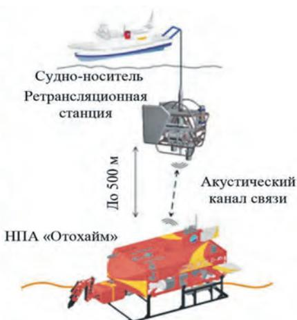
*Ретрансляционная станция (слева), схема работы НПА «Отохайм» с использованием ретрансляционной станции (справа)*
