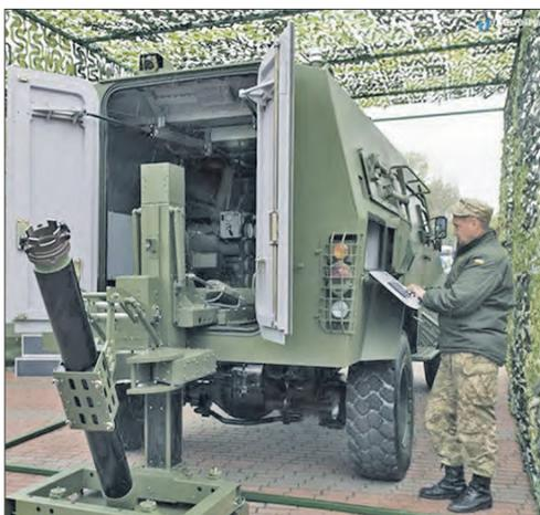
*Специалист проверяет действие гидравлической системы перевода установки в боевое положение*
