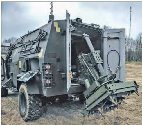
*На марше при помощи гидроприводов минометная система убирается внутрь корпуса*
