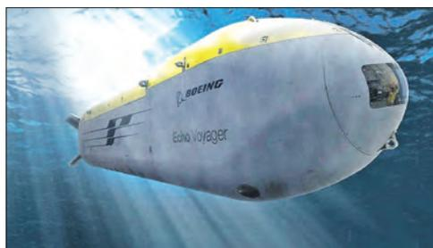
способна уничтожать и устанавливать морские мины, поражать торпедами надводные корабли и подводные лодки, вести радиоэлектронную борьбу, обнаруживать подлодки противника и передавать полученные данные кораблям и авиации. Длина беспилотника составляет 26 м, масса 80 т, максимальная дальность действия 6 500 морских миль. Аппарат способен находиться под водой более четырех месяцев.
