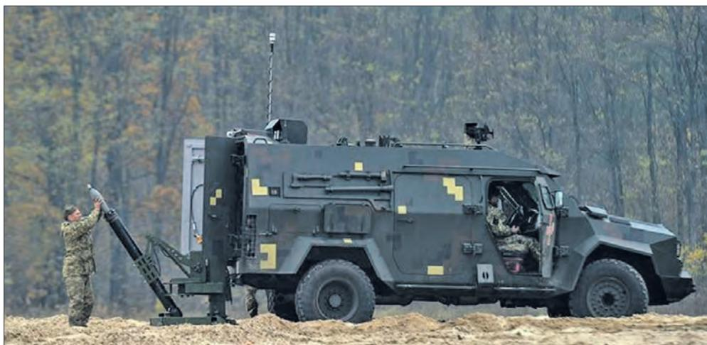
*Заряжание миномета производится в ручном режиме после его перевода в боевое положение*
