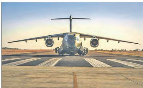
Модификация КС-390 оснащена оборудованием для дозаправки в воздухе, в том числе для приема топлива от другого такого же самолета с помощью подвесных топливных баков, установленных под крыльями воздушного судна. ВТС приспособлен к взлету и посадке на временные и грунтовые взлетно-посадочные полосы.
