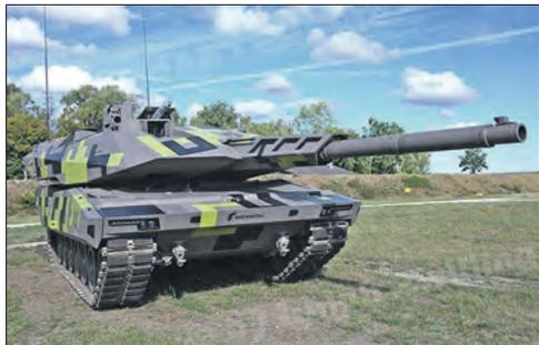
ставляет 288 млн евро. Танк будет оснащен 120-мм гладкоствольной пушкой и автоматом зарядания.
