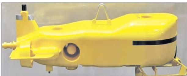
*Противоминный необитаемый подводный аппарат S-10*
