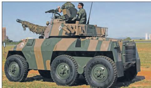
По данным пресс-службы СВ, БРМ получила обновленные шасси, башню, трансмиссию, ходовую часть, 90-мм пушку и систему управления огнем. Модернизацию машины проводит бразильская компания «Консорсиу Форса Террестре». Ранее сообщалось, что СВ Бразилии запланировали к 2031 году провести модернизацию 103 машин «Каскавел» из 600, состоящих на вооружении.
